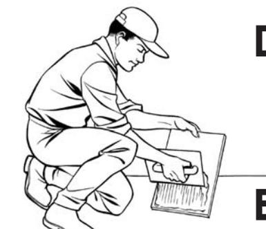
**D** Colocar el cemento cola en el reverso de la baldosa, con llana dentada de 6 a 8 mm (doble encolado).
