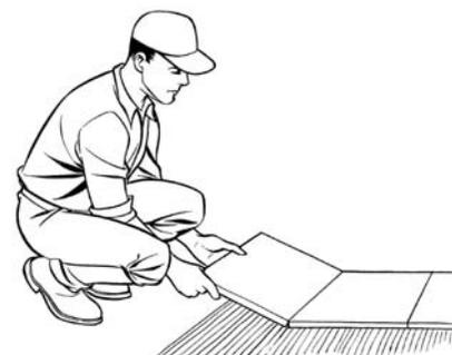
**E** Colocar las baldosas una detrás de otra, dejando juntas de dilatación cada 40 m<sup>2</sup>. Además dejar siempre una junta de dilatación perimetral de 5 mm y al menos 2 mm de junta entre baldosas.
