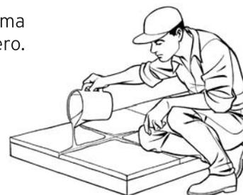
**H** Aplicar a las 24/48 horas lechada de cemento blanco, (BL V 22,5 UNE 80305 96), para rellenar las juntas entre baldosas o utilizar cementos de rejunte conforme a la norma UNE EN 13888.
